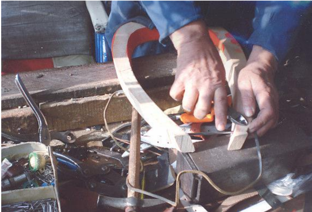
Fotoğraf 33: Hamut yapımı aşamalarından ağacın eğilmesi
